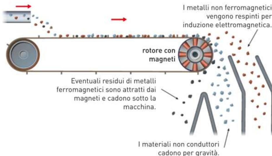
All'interno del rullo su cui gira il nastro si trova un rotore che sostiene rigidamente una serie di
